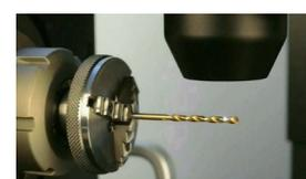
白色光を分光し、反射して返ってくる光波長によってZ方向を計測する色焦点プローブ(CFP)を直線的に192個配置した色焦点ラインセンサです。最大100万点のデータを3秒以内に取得することができ、面の3DフィットやSTL(ポリゴンデータ化)も可能です。対応可能な面性状も幅広く、乱反射面や鏡面、透明な表面や多層面にもご利用頂けます。
