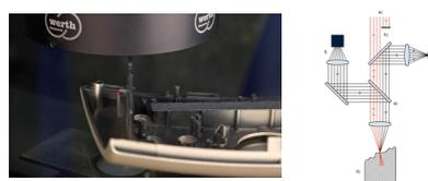
円形のレーザースポットをナイフエッジで半円にし、焦点からのズレ方向を半円の向きで検知できるようにしたZ方向測定用レーザー焦点プローブです。フィードバック制御により、常に焦点が合う高さに追従しながら指定した自由な経路をスキャンできます。様々な面性状に対応し、80°の斜面にも対応できるため、複雑な自由曲面の測定に最適です。
